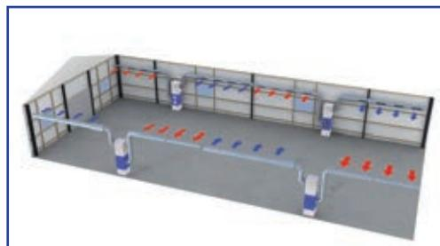
цехе на высоте максимальной концентрации сварочных дымов, очистки воздуха высокоэффективными фильтр-картриджами и выдувания («PUSH») обратно в цех очищенного воздуха через решетки воздуховодов с другой стороны системы.
