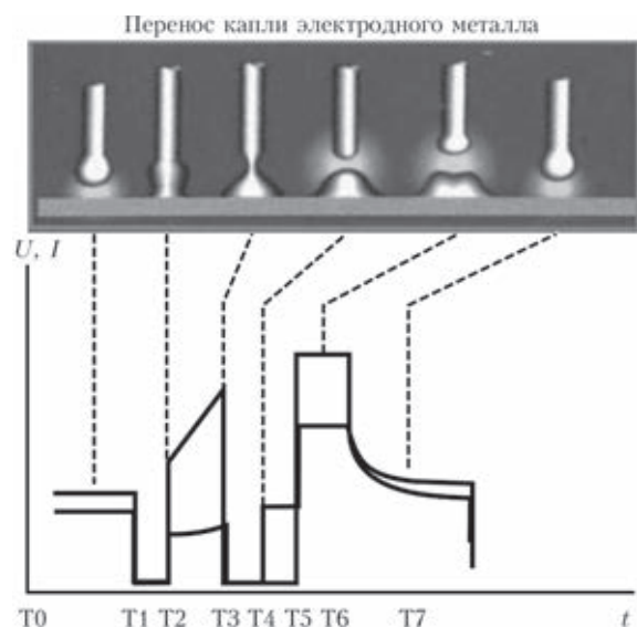
Рис. 1. Схема процесса MIG/MAG (метод STT)
