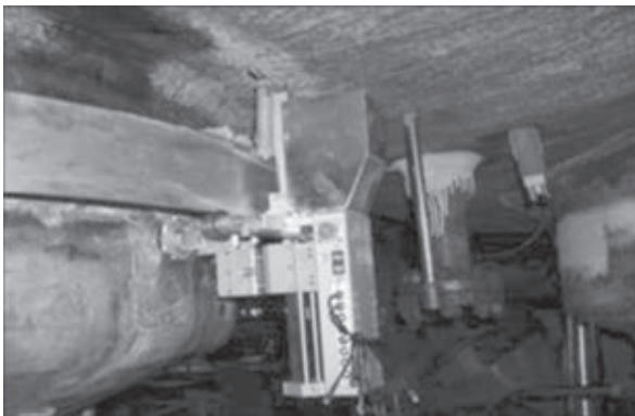
Рис. 8. Система АВГУР 5.2 для автоматизированного ультразвукового контроля гибов трубопроводов первого контура реактора ВВР-1000
