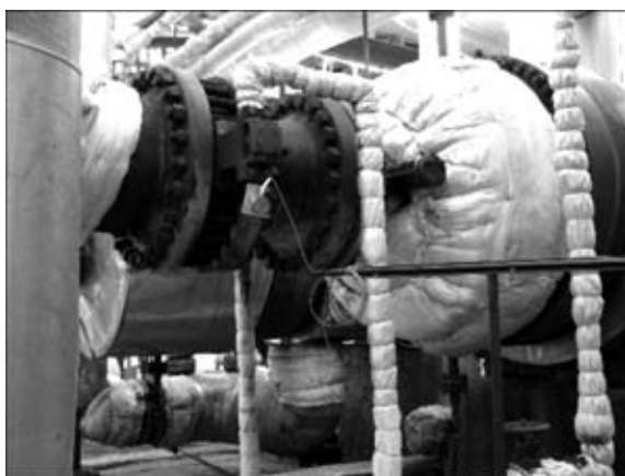
Рис. 1. Контроль теплообменника: на переднем плане виден АЭ датчик
