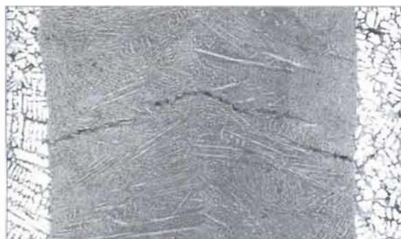
Рис. 2. Поперечная трещина в металле шва сплава ЖС-26 (X30)
