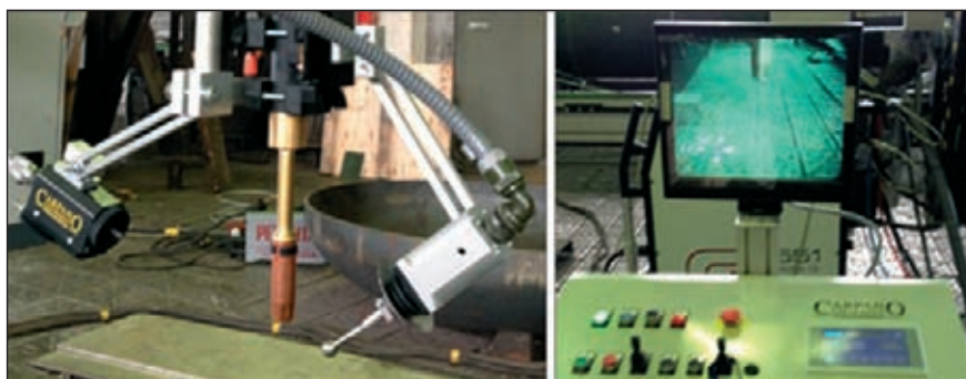
Рис. 6. Система видеонаблюдения для сварки в защитном газе
