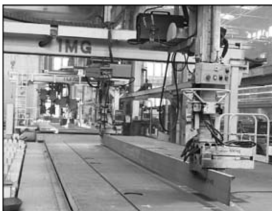
Рис. 1. Монтажный портал для ребер жесткости на линии по производству микропанелей
