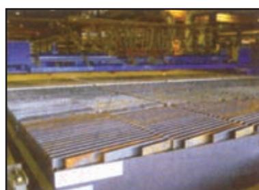
удаления или утилизации их. Для этого используют вытяжные вентилируемые столы и столы с водяной ванной.
