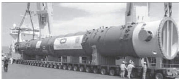
Рис. 9. Погрузка буферного сосуда-ловушки для конденсата вместимостью 500 т на грузовое судно в гавани Гемлика
