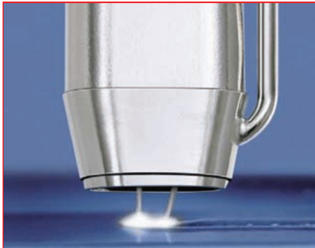
Высокопроизводительный способ сварки TimeTwin Digital двумя изолированными друг от друга плавящимися электродами в защитном газе
