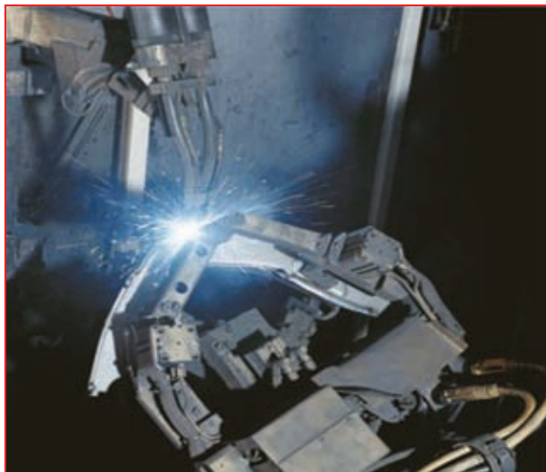
Тандем-сварка TimeTwin Digital позволяет достигать двух- или даже трехкратного увеличения скорости сварки при практически полном отсутствии брызг
