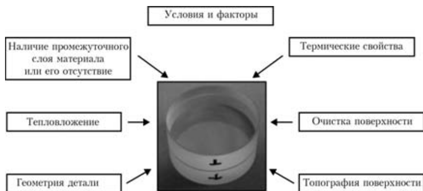
Рис. 2. Условия и факторы, влияющие на качество соединения, полученного диффузионной сваркой
