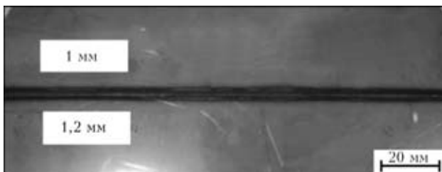
Рис. 3. Внешний вид лицевой поверхности шва на ССЗ, сваренной на оптимальных режимах
