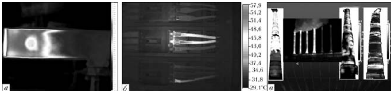
Рис. 2. Экзаменационные образцы: а — образец с внутренними дефектами из стеклопластика; б — контактное соединение-термограмма; в — дымовые трубы — термограмма
