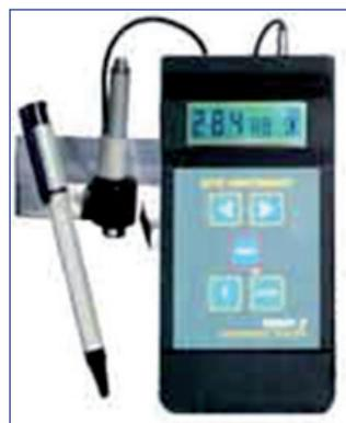
Аналог прибора DYNAMIC. Прибор «ТЭМП–2» (НПП "Технотест-М") позволяет проводить экспрессное измерение твердости материала непосредственно в единицах HB, HRC, HV, HSD и дополнительно вводить до 10 шкал для измерения твердости на других материалах при наличии корреляционной связи с динамической твердостью по Лейбу.
