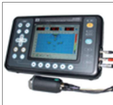
Легкий и удобный в использовании прибор для решения большинства задач ультразвуковой дефектоскопии металлов и пластмасс. Обеспечивает быстрый, комфортный и достоверный поиск дефектов благодаря визуализации внутренней структуры объекта контроля в виде изображения сечения в режиме реального времени, что существенно упрощает и делает более доступной интерпретацию полученной информации по сравнению с обычным дефектоскопом.
