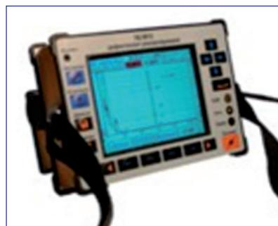
Ультразвуковой дефектоскоп УД9812 «Уралец» (ООО "Инженерный Центр Физприбор") предназначен для:
