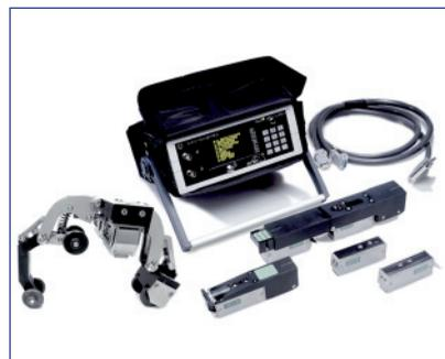
Устройство **УМБТ2** применяется в составе установки УИУ **СКАРУЧ** для контроля основного металла бурильных труб: поиска коррозии в основном металле трубы (4-мя ПЭП); поиска дефектов продольной ориентации (4-мя ПЭП); поиска дефектов поперечной ориентации (4-мя ПЭП). Контроль ведётся в щелевом варианте акустического контакта. Контактная жидкость – вода.
