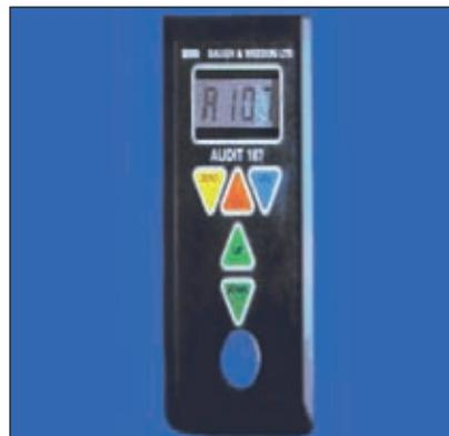
дить инспекцию различных видов материалов. Пользователь может устанавливать необходимые скорости звука для тестируемого материала или может выбирать калибровку прибора по стандарту известной толщины. Прибор защищен от воздействий окружающей среды по IP65, укомплектован щупом DT25, предназначенным для работы в трудных условиях.
