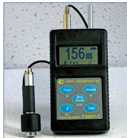
Может быть использован в производственных и лабораторных условиях в различных отраслях машиностроения, металлургии, энергетике, в ремонтных, монтажных организациях и т.д. Объектами измерений могут быть сосуды давления различного назначения, трубопроводы, роторы турбин и генераторов, прокатные валки, коленчатые валы, шестерни, промышленные полуфабрикаты (отливки, поковки, листы, трубы), сварные швы включая угловые и др.
