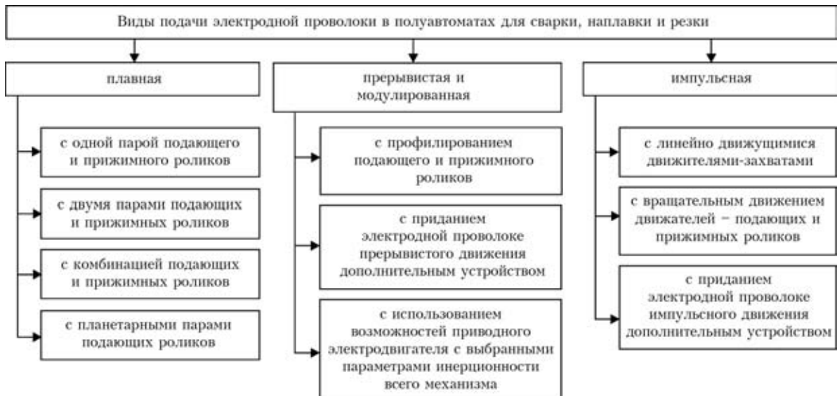
Рис. 1. Классификация основных типов механизмов подачи электродной проволоки
