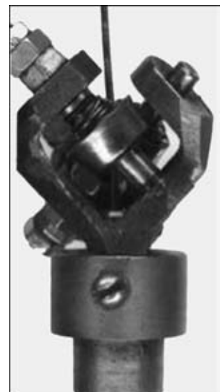
Рис. 2. Планетарный механизм подачи электродной проволоки
