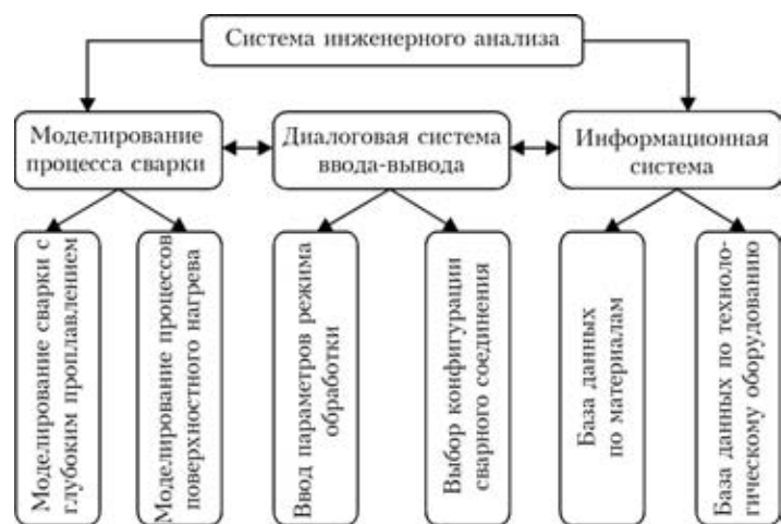
Рис. 1. Блок-схема системы LaserCAD лучевой сварки металлов
