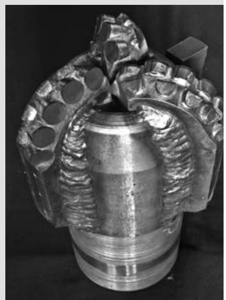
Долото с алмазно-твёрдосплавными резцами для подземного бурения
