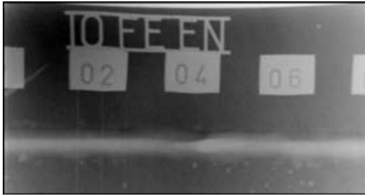
Рис. 14. Рентгенограмма участков в области нахлестки стартовых зон (положение 12 ч)
