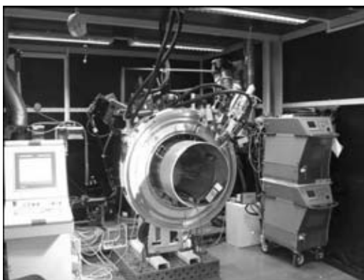
Рис. 12. Прототип оборудования для гибридной сварки трубопроводов
