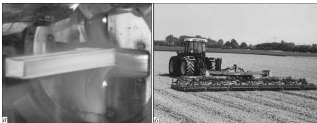
Рис. 1. Изготовление MSH-профилей квадратного сечения в последней прокатной клети (а) и их применение в сельскохозяйственном машиностроении (б)
