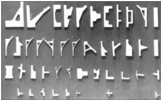
Рис. 1. Примеры профилей из алюминиевых сплавов, свариваемых КССО
