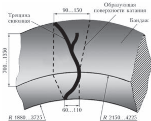
Рис. 1. Схема характерного расположения трещин в разрушенном бандаже вращающейся печи
