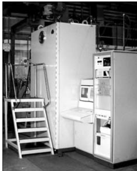
Рис. 8. Внешний вид специализированной установки УЛ-178М для электронно-лучевой сварки труб с трубными досками
