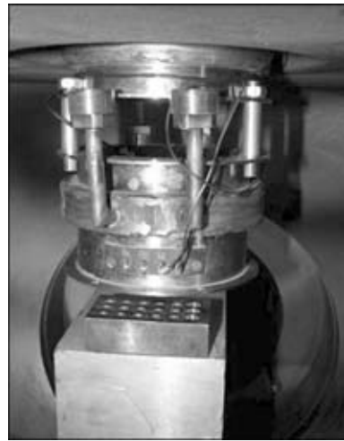
Рис. 2. Внешний вид отклоняющей системы с двойным преломлением электронного пучка, установленной на электронно-лучевой пушке ЭЛА-60/15
