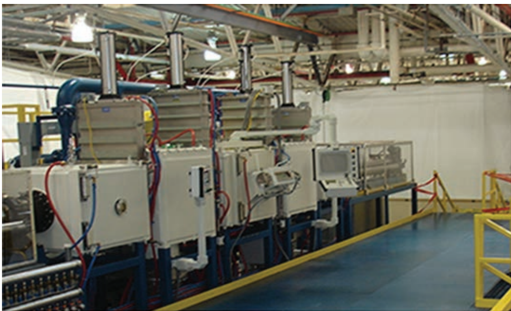
Спроектированная и изготовленная Pratt & Whitney-Paton электронно-лучевая установка для нанесения защитных покрытий на лопатки авиационных газовых турбин на предприятии у заказчика
