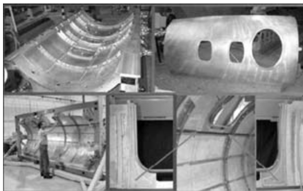
Рис. 5. Устранение заклепочных соединений швов внахлестку при применении СТП (режим доступа: http://www.dvs-ev.de/lvmv/downloads/schweibote0207.pdf )
