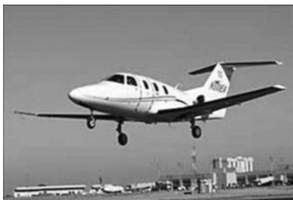
Рис. 1. Первый испытательный полет самолета «Eclipse 500» (при изготовлении использовали СТП) [1]
