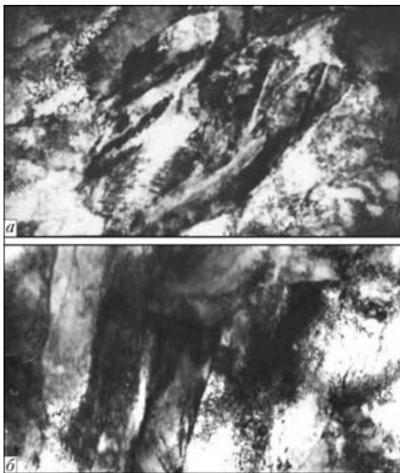
Рис. 6. Микроструктура ( \times 15000 ) микрофазы в высокотемпературной зоне охрупчивания металла внутреннего шва при различном его легировании: a — Ti + V + Nb = 0,04\% ( Ti = 0,03\% ); b — Ti + V + Nb > 0,06\% ( Ti практически отсутствует)
