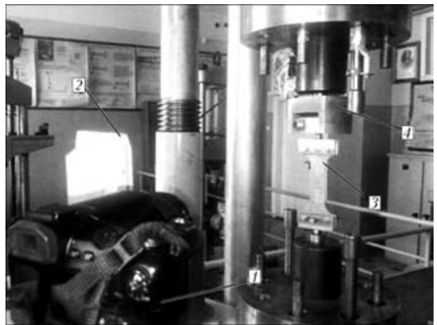
Рис. 1. Апаратна частина для реєстрації поля деформації: 1 — цифрова камера; 2 — джерело світла; 3 — зразок з нанесеною стохастичною текстурою; 4 — динамометр
