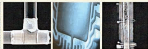
Применение Ф/Р в промышленности: пайка медных труб, фрагмент микросхемы X100, коррозия под изоляцией
