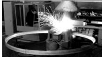
Контактная стыковая сварка шпангоутов на машине К393
