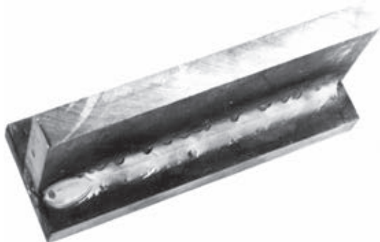
Рис. 2. Внешний вид углового шва, выполненного в смеси Ar + 20 % CO 2 проволокой Sv-08Г2С диаметром 1,2 мм при I св = 260 А, U д = 28 В
