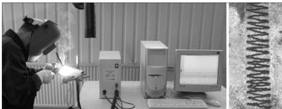
Рис. 2. Обучение с помощью тренажера сварщика ДТС-02
