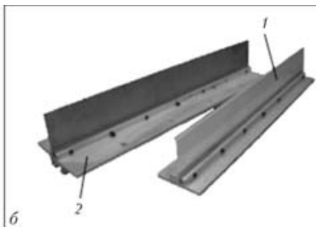
Рис. 1. Внешний вид свариваемых деталей — направляющей кресел (а) и балки упрощенной конструкции для экспериментальных исследований (б); 1, 2 — соответственно алюминиевая и титановая часть сварной балки
