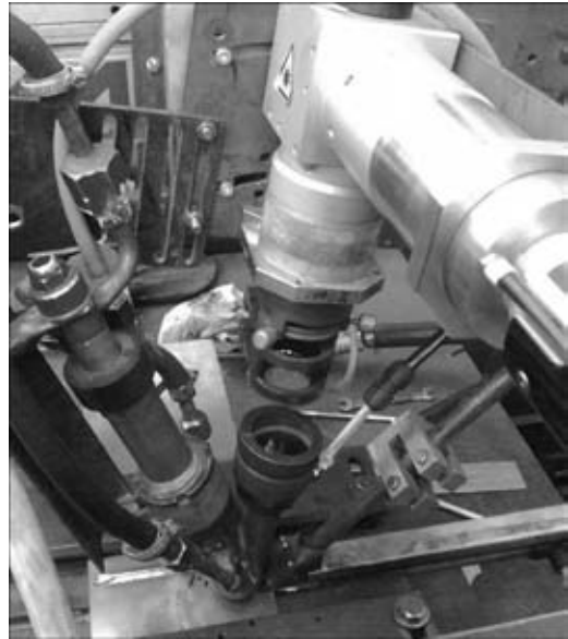
Рис. 2. Внешний вид сварочной головки для лазерно-дуговой сварки титановых сплавов
