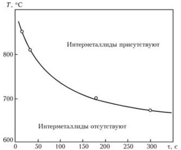
Рис. 4. Температурная зависимость длительности \tau латентного периода образования интерметаллидного соединения \text{TiAl}_3 на границе поверхностного контакта твердого титана с жидким алюминием [5]
