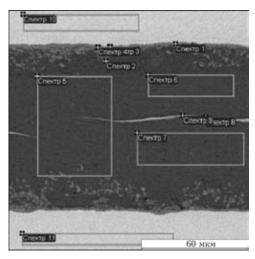
Рис. 2. Микроструктура участка паяного соединения из титанового сплава OT4, выполненного припоем AMr6
