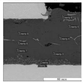
Рис. 1. Микроструктура галтельного участка паяного соединения из титанового сплава ОТ4, выполненного припоем AMr6
