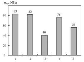
Рис. 4. Прочность нахлесточных соединений сплава ОТ4 (время выдержки 3 мин), запаянных следующими припоями: 1 — TiBrazeAl-642; 2, 3 — AMr6; 4 — AД1; 5 — TiBrazeAl-665 (1, 2, 4, 5 —  $T_{\rm H}$  = 685; 3 — 720 °C)
