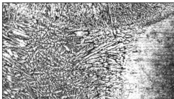
Рис. 2. Первичная микроструктура металла двухслойного шва (×50)
