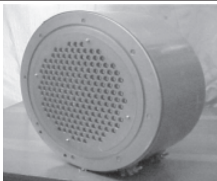
Рис. 2 Фотография источника ионов “Радикал-М250”
