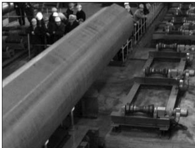
Линия одношовной сварки труб большого диаметра
