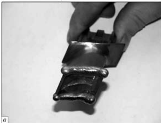
Рис. 6. Геометрические характеристики зоны ремонта (а, б) и внешний вид (в) восстановленной рабочей лопатки ТВД из сплава ЖС32-ВИ: □, ■ — занижение поврежденной поверхности перед наплавкой соответственно на 1,0 и 2,5 мм в партии из N = 100 лопаток; \delta — ширина торца бандажной полки
