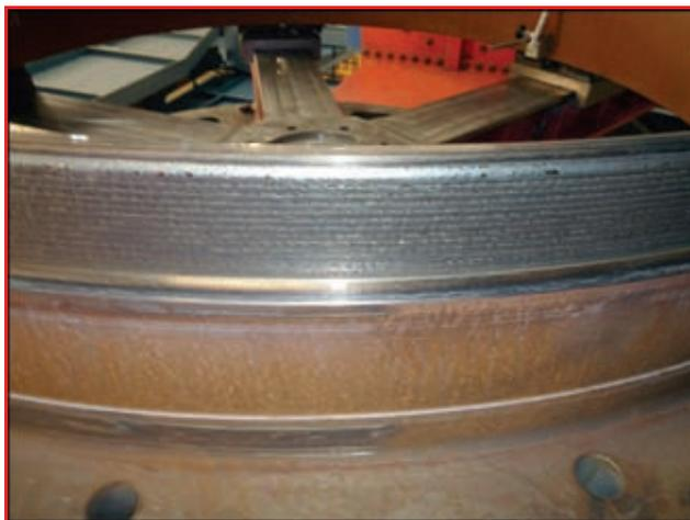
Использование метода СМТ позволяет специалистам компании «Andritz Hydro» выполнять плакирование значительно быстрее, эффективнее, а также повышает автоматизацию процесса — например, при работе с уплотнительными фланцами для плакирования и создания сварных соединений
