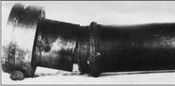
Рис. 11. Деталь реактивной штанги после циклических испытаний
