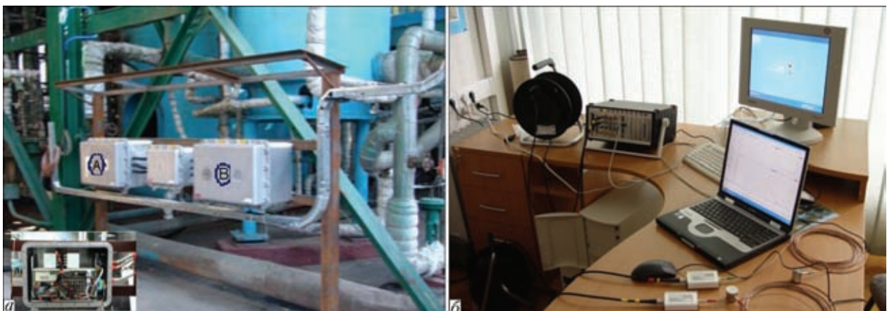
Рис. 6. Стационарный (а) и мобильный (б) варианты диагностической системы семейства ЕМА
