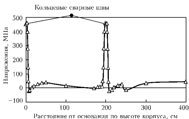
Рис. 4. Суммарные напряжения в оболочке корпуса хранилища
