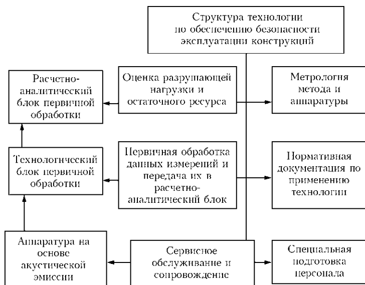
Рис. 3. Схема технологии контроля системой ЕМА 3
