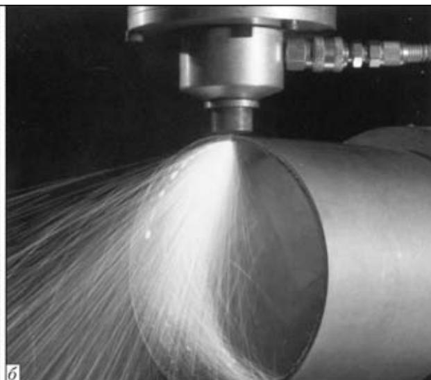
Поверхность бетонной плиты после удаления загрязненного слоя путем ее обработки лазерным лучом (а) и процесс лазерной резки трубы на отдельные фрагменты (б)
