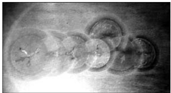
Рис. 1. Поперечный макрошлиф образца из стали 35Л размером 500×300×500 мм с горячими трещинами, образовавшимися после ЭШС отверстий диаметром 50 мм и глубиной 500 мм
