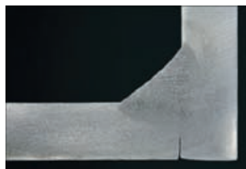
Сварной шов, выполненный методом TimeTwin (угловой шов, сталь 8 мм, v_{св} = 80 см/мин, производительность наплавки до 22 кг/ч)
