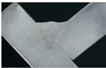
Сварной шов, выполненный методом TIME (угловой шов, сталь 20 мм, a = 8 мм, производительность наплавки 16,2 кг/ч)
