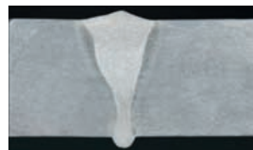
Сварной шов, выполненный методом LaserHybrid (стыковой шов, сталь 12 мм, сварочная головка 10 кВт)
