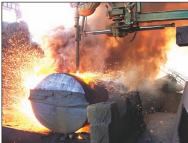
Резка заготовки диаметром 650 мм на машине «Терминатор»
