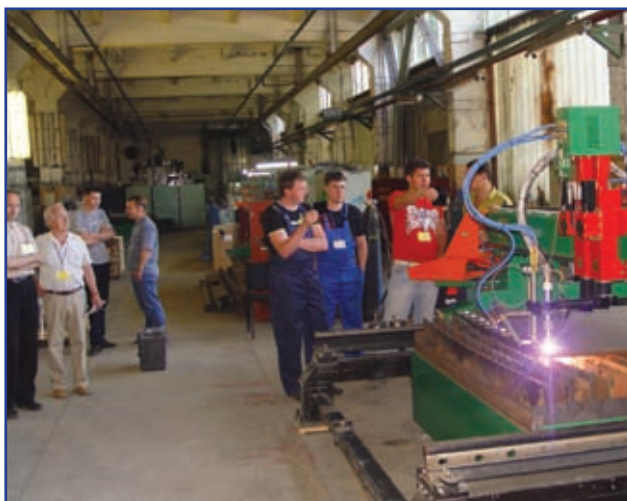
Демонстрация участникам конференции технологии плазменной резки TrueHole
