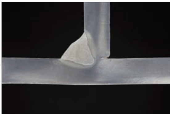
Пример сварного шва, выполненного методом CMT Twin (угловой шов, сталь толщиной 10 мм, V_{св} = 150 см/мин)
