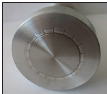
Рис. 2. Штифты на валу из высоколегированной стали служат в качестве анкеров или геометрически замыкаемых «зацепляющихся крючков» для алюминиевой оболочки
