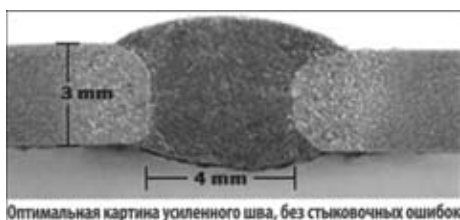
Оптимальная картина усиленного шва, без стыковочных ошибок
