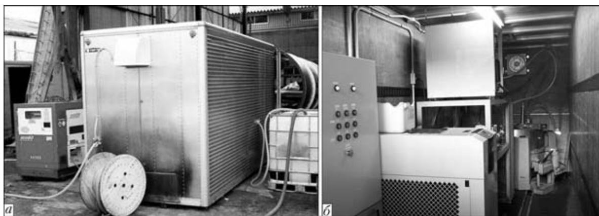
Рис. 2. Плазменный модуль: а — общий вид мобильной плазменной установки для очистки радиоактивной воды; б — блочно-модульное исполнение плазменной установки
