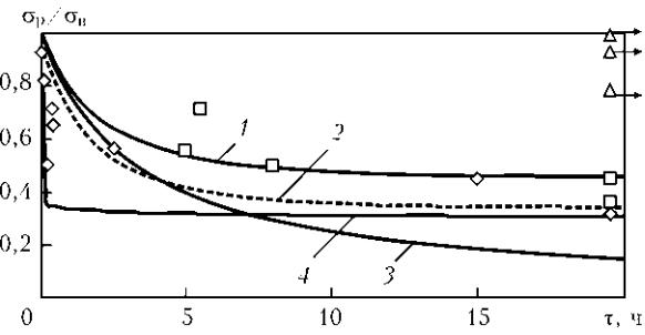
Рис. 2. Расчетные (кривые 1–4) и экспериментальные данные (значки) с разными ядрами последействия: 1, 2 — ядро последействия тела Кельвина при соответственно содержании в образце  $[H]_0 = 5,0$  и  $15 \text{ мл}/100 \text{ г}$ ; 3 — ядро Максвелла при  $[H]_0 = 5,0 \text{ мл}/100 \text{ г}$ ; 4 — степенное ядро при  $[H]_0 = 15 \text{ мл}/100 \text{ г}$
