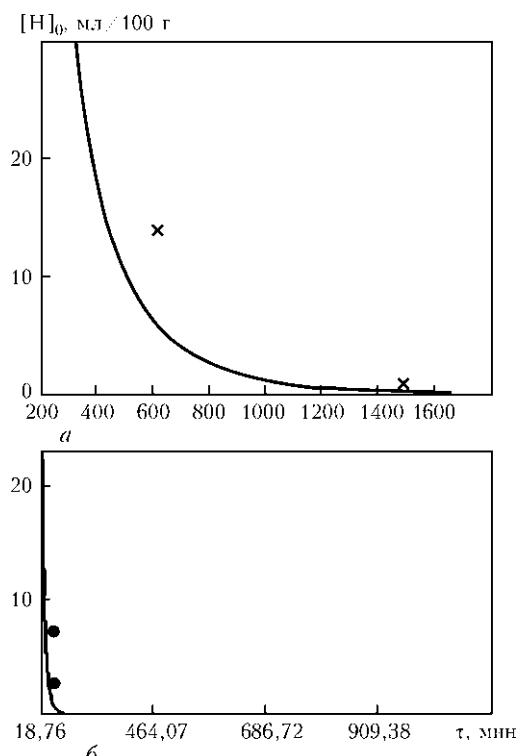
Рис. 3. Влияние содержания водорода в образцах на замедленное разрушение при нагрузках  $\sigma_p = 300$  (×) и 650 МПа (•) (×, • — экспериментальные точки)
